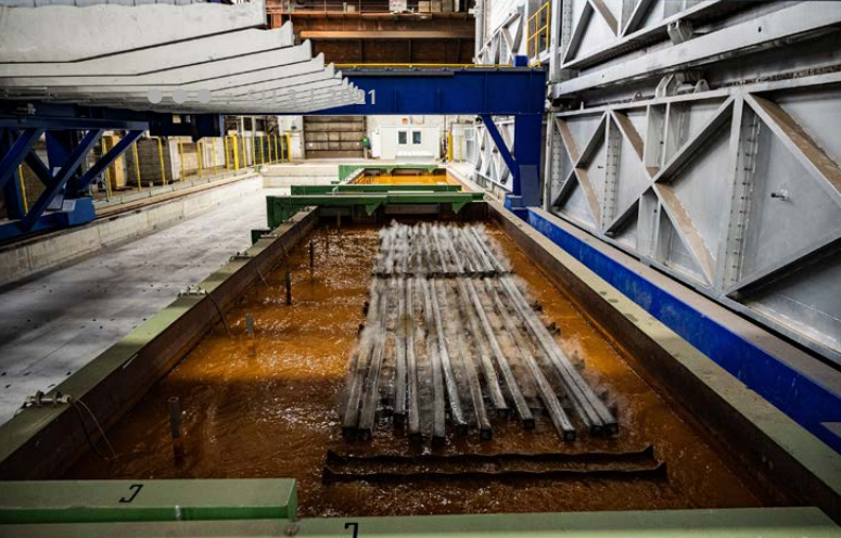
Izboljšanje mehanskih lastnosti jekla SINOXX s kaljenjem v polimeru, ki mu sledi še popuščanje.
