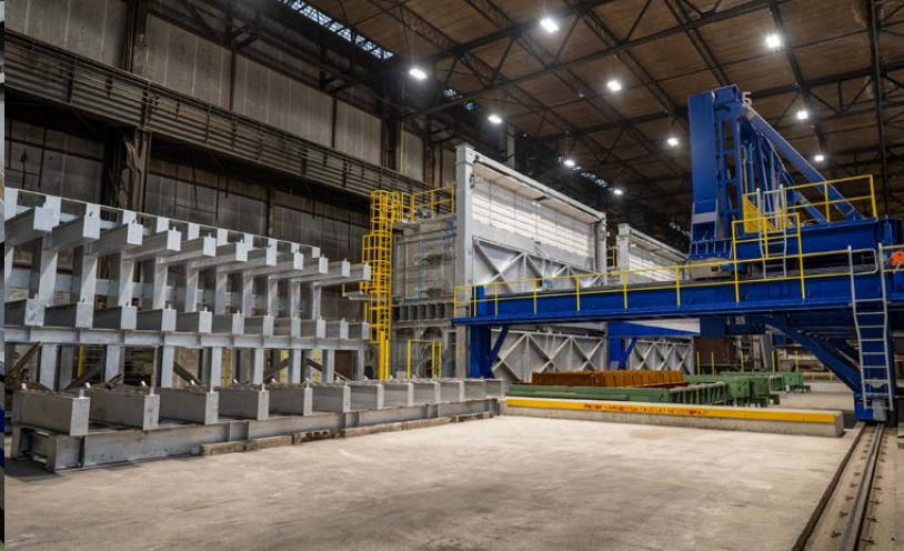
Kalilno-popuščna linija s šaržirnim manipulatorjem in kalilnima bazenoma
