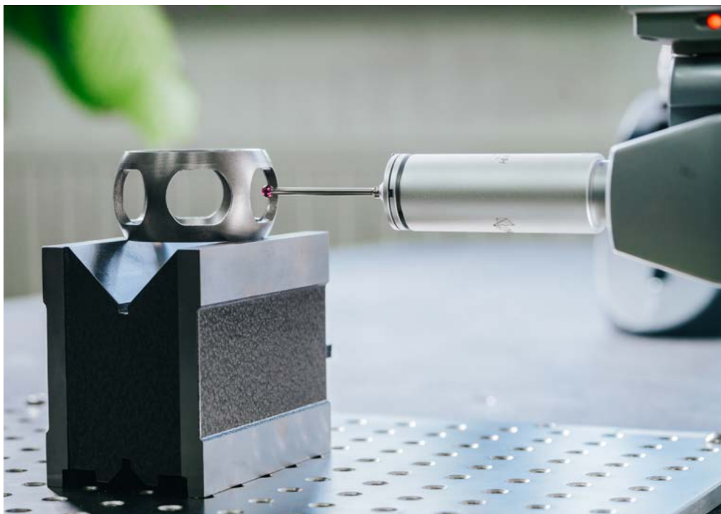
Precizno geometrijsko merjenje s trikoordinatnim merilnim strojem
