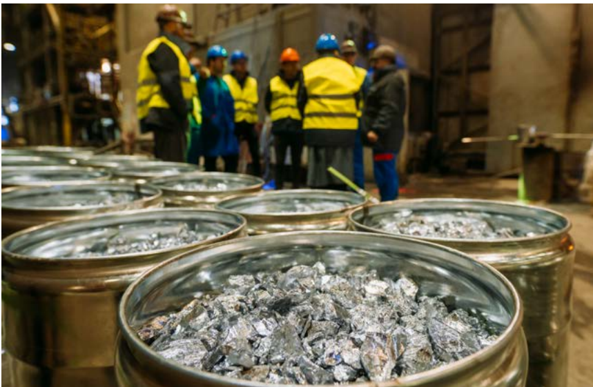
Skrbno pripravljene legure pred pretaljevanjem prve šarže
