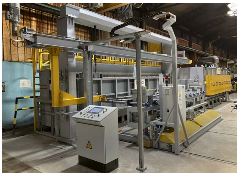
Nova kalilna linija je računalniško vodena in povezana v naš informacijski sistem.
