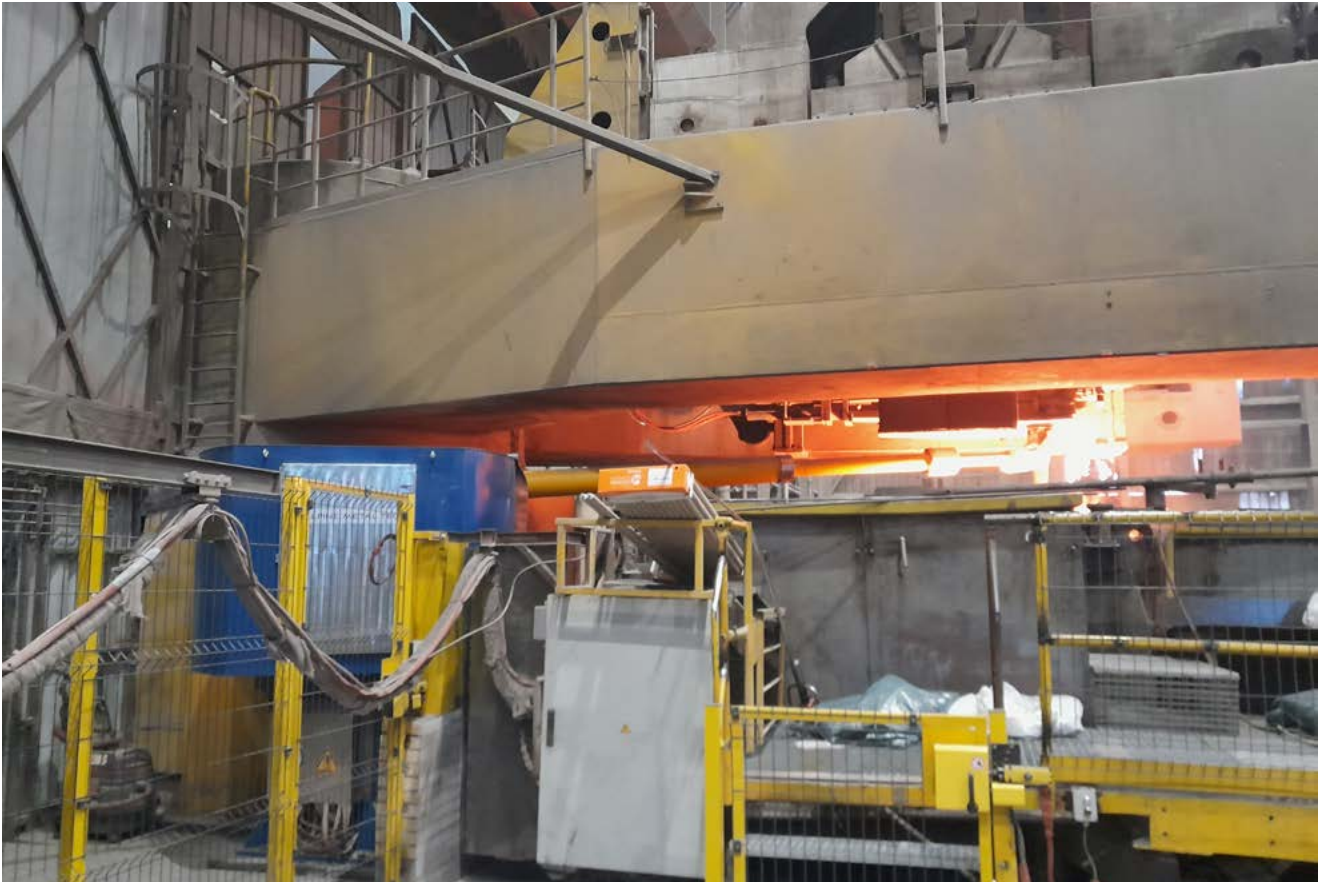
Novi manipulator med vlivanjem
