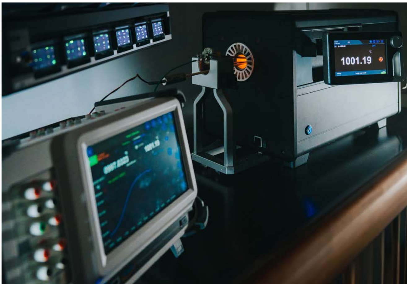
Kalibracija K-tipa termočlena pri temperaturi 1000 °C
